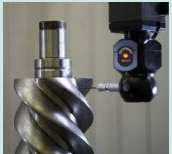
Pomiar 3D każdego wyprodukowanego elementu
